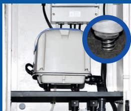
**Wandhalterung (Serie) zur Außen- und Innenaufstellung mit Steuereinheit**, netzunabhängiger Stromausfallerkennung (NUSA), Ventilen und energieoptimierten Verdichtern bis zu einer **Wassertiefe der Kleinkläranlage von 1,60 m, 2,05 m oder 2,30m**, Maße (B,H,T) 396x520x245 mm. Innenansicht mit serienmäßig schwingungsgedämpften Gerätefüßen des Membranverdichters.
