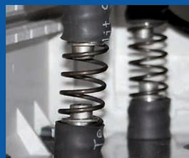
**Wandhalterung "Komfort" (optional)** Innenansicht mit optimierter, nahezu schwingungsfreier Aufstellung des Membranverdichters für besonders geräusch- und vibrationssensible Anwendungs- / Einsatzbereiche.
