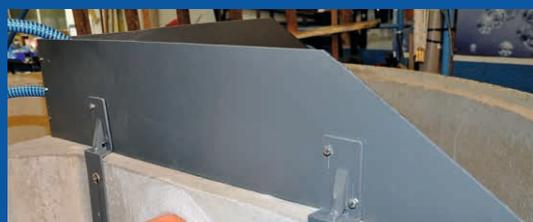
**Trennwanderhöhung** verhindert ein Abtreiben der Aufwuchskörper. Die Überlaufgarnitur sorgt für einen optimalen Zulauf in die Wirbelschwebbettkammer.
